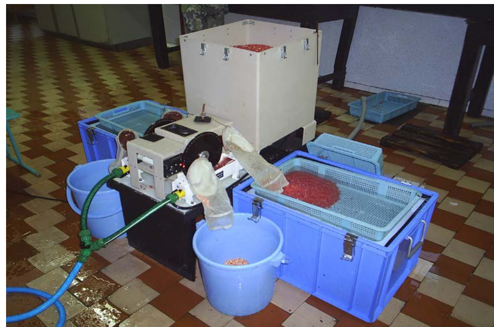
Рис. 37. Икроотборочный аппарат типа JX, Таранайский ЛРЗ
